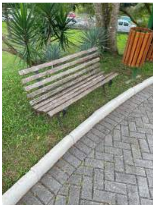
Fotografia 124 - Degradação de madeira
